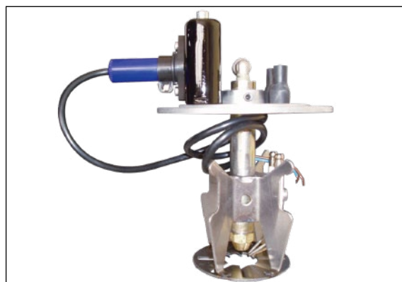
安装在铝制法兰上的支撑架可以固定光传感器
